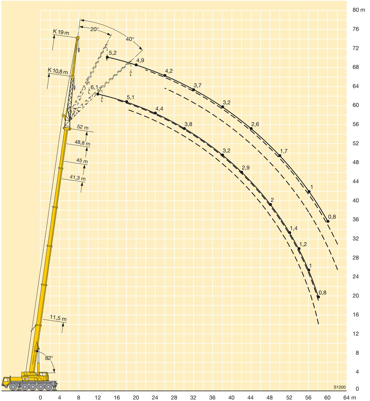
**Traglasten an der hydraulisch verstellbaren Klappspitze
