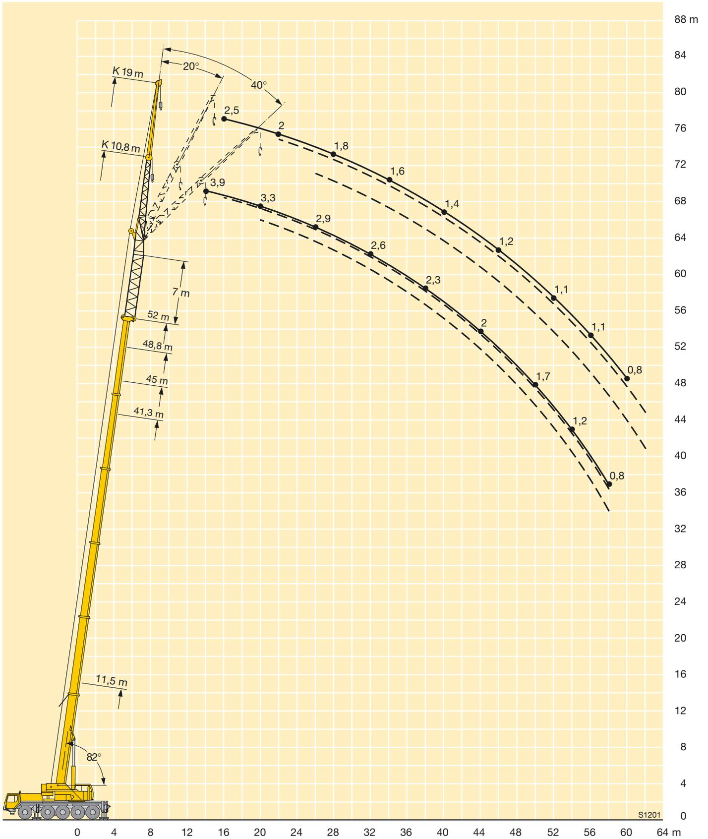
**Traglasten an der hydraulisch verstellbaren Klappspitze mit verlängertem Teleskopausleger**
